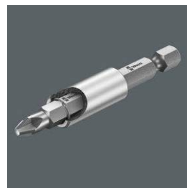
Universalhalter mit Edelstahl-Hülse Mit Sprengring und starkem Dauermagnet für besonders sicheren Sitz des Bits im Halter.
