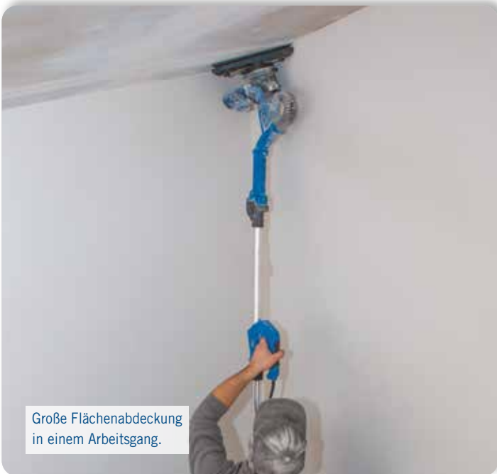
Einfaches Erreichen der Ecken, dank des Dreieckschleifkopfes.
