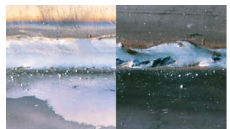
Vor dem Schweißen entzünderte Flächen führen zu saubereren Schweißnähten (s. Abb. links)
