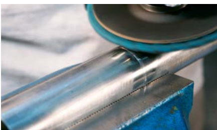
Verschleifen feiner Schweißnähte und Entfernen von thermischen Blauverfärbungen
