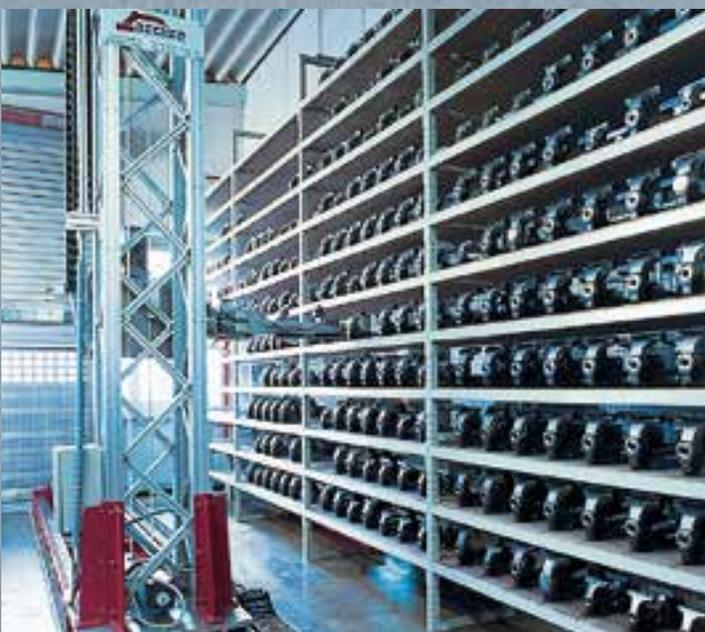
Vollautomatisches Zwischenlager und Verteilerzentrum
