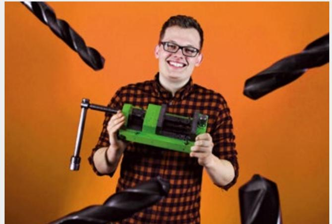
Dafür entwickelte der Jungforscher einen neuartigen Schraubstock mit einem unterhalb integrierten Befestigungsmechanismus: Ein sogenannter Spannhebel kann dabei per Hebelwirkung und mit einer Schraube sehr fest an den Tisch gezogen und so gut justiert werden.
