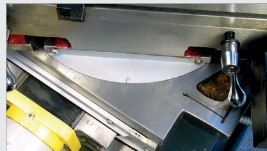
Kreuztisch 45° nach links und 45° nach rechts drehbar
