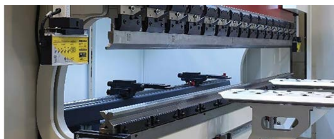
ABB.: ARBEITSRAUM GESENKBIEGEPRESSE (GBP 2.550-120 CNC) MIT SONDERZUBEHÖR SCHNELLWECHSELHALTER UND BLECHHOCHHALTER
