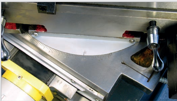
Kreuztisch 45° nach links und 45° nach rechts drehbar.
