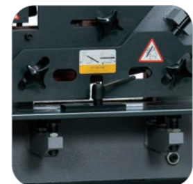
Flachstahlstation Tisch mit Winkelanschlägen und einstellbarem Niederhalter
