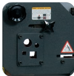
Stangenstahlstation mit Niederhalter
