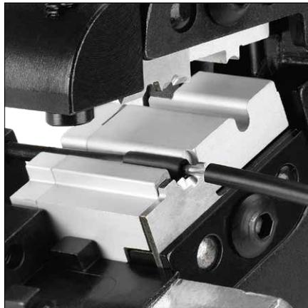
Abisolieren des Kabels sowie...
