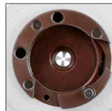
Adapterring an Zangen für Mehrfach-Stiftkontaktaufnahmen
