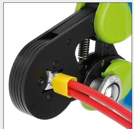
Verarbeitung von Twin-Aderendhülsen bis max. 2 x 6 mm<sup>2</sup> / 2 x AWG 8
