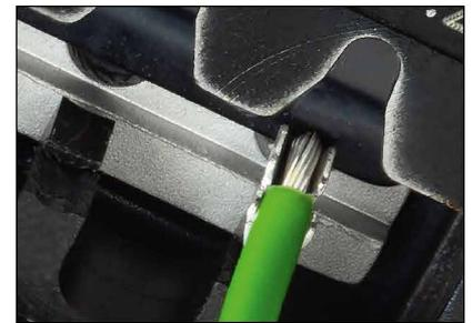
Die schwenkbare Kontaktaufnahme dient zum exakten Ausrichten und Fixieren des Kontaktes sowie als Drahtanschlag für das Kabel. In Verbindung mit der parallelen Crimpbackenzustellung und der Zwangsvollendung des Crimpvorganges entsteht eine perfekte Crimpverbindung.
