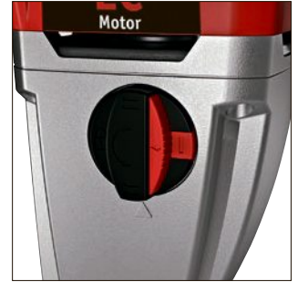
Patentierter Spindelarretierung Mit Anlaufschutz für einen werkzeuglosen Rührstabwechsel. Dreheschieber zur Einstellung der optimalen Mischgeschwindigkeit. Getriebestufe 1: für hochviskose Baustoffe, Getriebestufe 2: für mittel- und niederviskose Baustoffe
