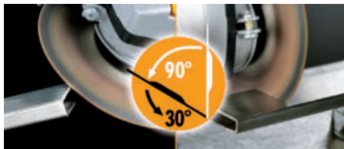
Extradünnes Trennen und Schleifen mit einer Scheibe
