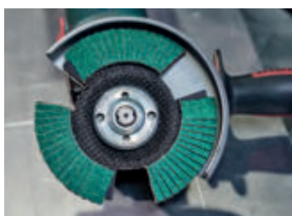
Drei clevere Aussparungen für freie Sicht auf das Werkstück...
